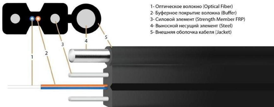
? Что из себя представляет оптический кабель? Фактически, передающий данные элемент – это тоненький стеклянный волосок толщиной 0,125 мм, покрытый сверху лаком и упакованный в защитную оболочку. Стекло – достаточно хрупкий материал, поэтому кабель чувствителен к ударным нагрузкам, резким рывкам и сильным изгибам.
